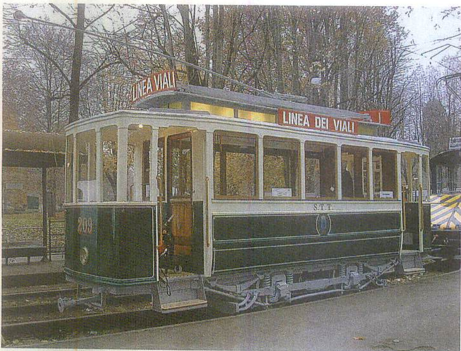
Elettromotrice 209, fresca di restauro a cura dei soci ATTS con la tradizionale presa di corrente ad asta e rotella; sullo sfondo si intravede uno scorcio del "trattore" T450 che l'ha trainata fino al luogo dell'esposizione (foto I. Arena).
